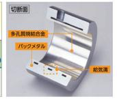
すべり軸受のノウハウを生かした多孔質技術により、多孔質層から圧縮した空気を吹き出し、相手材との間に 空気膜を構成します。
