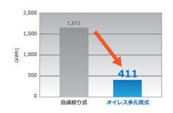
独自の多孔質式絞りの構造により、消費流量を抑えることができ、 消費電力の削減およびCO<sub>2</sub>排出量の削減が可能になります。
